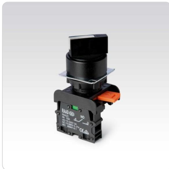
کلید سلکتوری رعد مطابق با استاندارد IEC60947-5-1 با قابلیت 22 میلی متر طراحی گردیده است. این محسولات در محدوده ولتاژ 240 ولت و جریان 3 آمپر تولید شده است.
