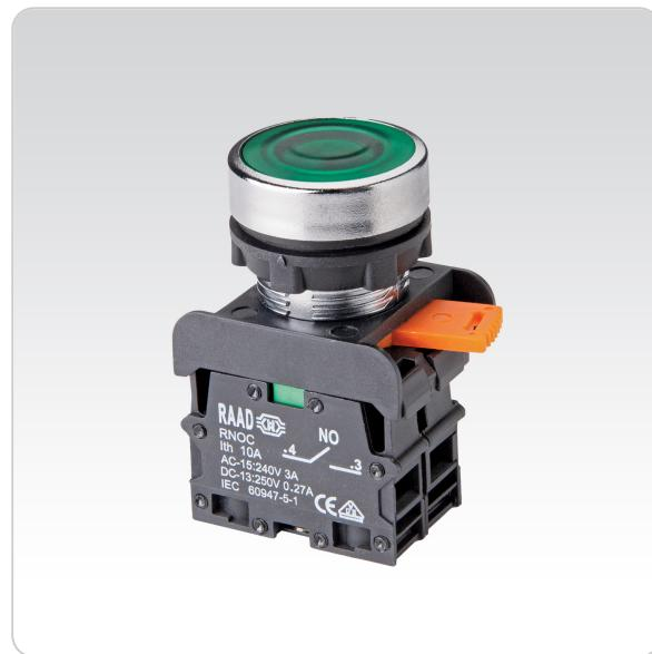
کلید های کنترل رعد مطابق با استاندارد IEC 60947-5-1 و با قطر 22 میلی متر طراحی گردیده است. از انواع این کلیدها می توان به کلید استپ و استارت، کلید استپ و استارت دوبل، کلید سلکتوری به همراه واشر ضد چرخش و کلید قطع اضطراری قفل شونده اشاره نمود. این محصولات در محدوده ولتاژ 240 ولت و جریان 3 آمپر تولید شده است.
