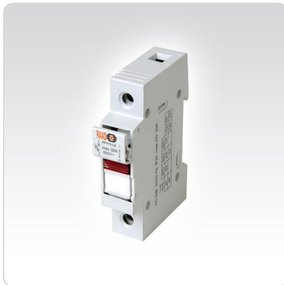
استفاده از فیوز هولدر شرکت رعد، راه حلی مطمئن برای حفاظت و ایزوله کردن مدارات از اتصال کوتاه و اضافه بار می باشد. RFH10 با توجه به گروه کاربردی AC-22B ، مطابق با استاندارد IEC60947-3 ، برای سونچینگ تحت بار و حفاظت طراحی شده است. از این محصول می توان در تابلوهای سونچینگ اتوماسیون جهت سونچینگ بارهای ترکیبی مقاومتی و القایی استفاده نمود؛ همچنین جهت حفاظت از مدارات کنترلی، ترانسفورماتورهای اولیه و ثانویه، موتورها و دیگر بارهای مقاومتی یا القایی مورد استفاده قرار می گیرد.
