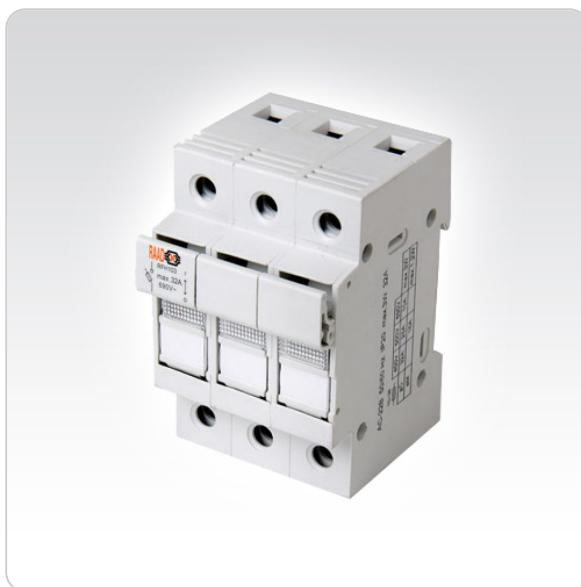
استفاده از فیوز هولدر شرکت رعد، راه حلی مطمئن برای حفاظت و ایزوله کردن مدارات از اتصال کوتاه و اضافه بار می باشد. RFH10 با توجه به گروه کاربردی AC-22B، مطابق با استاندارد IEC60947-3، برای سوئیچینگ تحت بار و حفاظت طراحی شده است. از این محصول می توان در ناپلهای سوئیچینگ اتوماسیون جهت سوئیچینگ بارهای ترکیبی مقاومتی و القائی استفاده نمود؛ همچنین جهت حفاظت از مدارات کنترلی، ترانسفورماتورهای اولیه و ثانویه، موتورها و دیگر بارهای مقاومتی یا القائی مورد استفاده قرار می گیرد.
